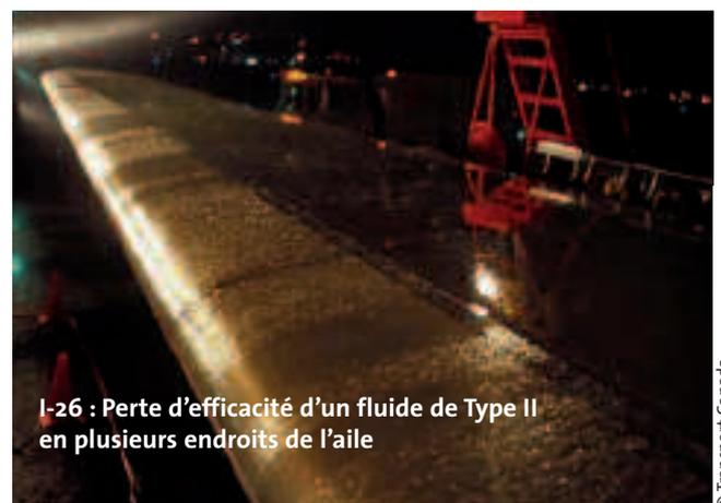
I-26 : Perte d'efficacité d'un fluide de Type II en plusieurs endroits de l'aile
