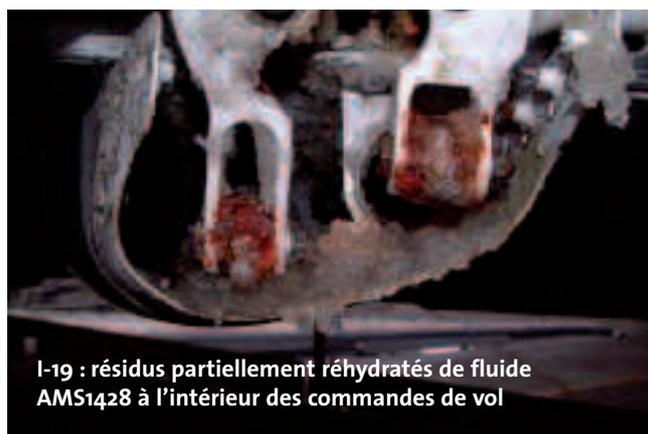
I-19 : résidus partiellement réhydratés de fluide AMS1428 à l'intérieur des commandes de vol
