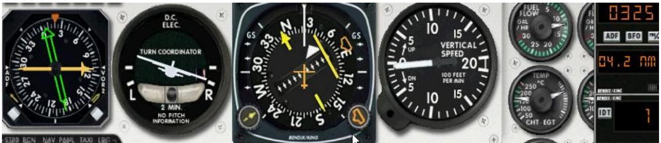
On arrive au QDM interception. On règle la pinule sur le cap corresponddant au QDM destination.
