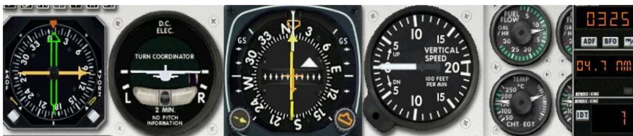
On va régler le harpon sur le QDM destination et la pinule de cap à 80° du QDM initial.
