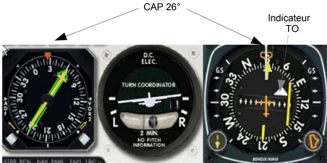
Le RMI nous indique que la station se trouve à 34° de notre cap sur le QDM 60°. Pour rejoindre la station directement il suffit de prendre un cap 60°
