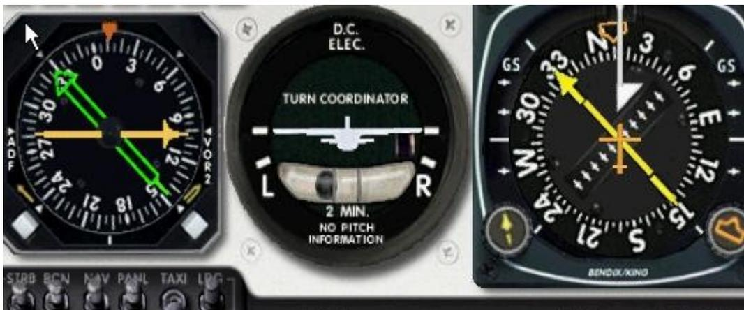
En gardant ce cap, le QDM a diminué de 10° = 330°. et ainsi de suite jusqu'au QDM 300°
